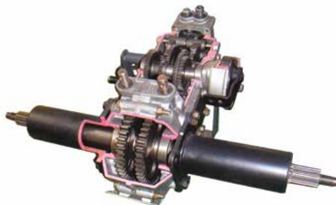
1. Alcuni modelli montano una trasmissione meccanica a sei marce che offre una grande varietà di velocità (quasi come un idrostatico): le marce lente per la raccolta o per le forti pendenze e le marce veloci per gli spostamenti (BP31, BP35, BH41).
